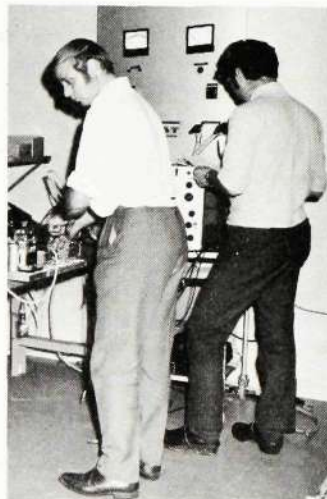
Fr. v. Alf Lindström och Nils Lindblad, båda K74, provar filterenheten för 630 ampéers omriktare.
