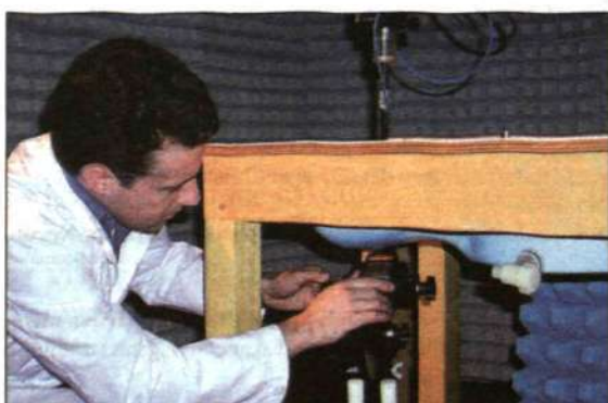
Mätningar av elektromagnetiska fält utförs bland annat vid Ericsson EMF Research Laboratory i Kista. Forskningsingenjör Martin Siegbahn placerar en mobiltelefon på ett stativ under ett huvudformat plastskal, fyllt med en vätska med samma elektriska egenskaper som vävnaden i ett människohuvud.
