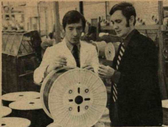
Platschefen Ulf Norberg (t h) granskar här tillsammans med kontrollchefen Pentti Kerovirta en plastisolerad enkelledare innan den går in i nästa operation, tvinningen.
