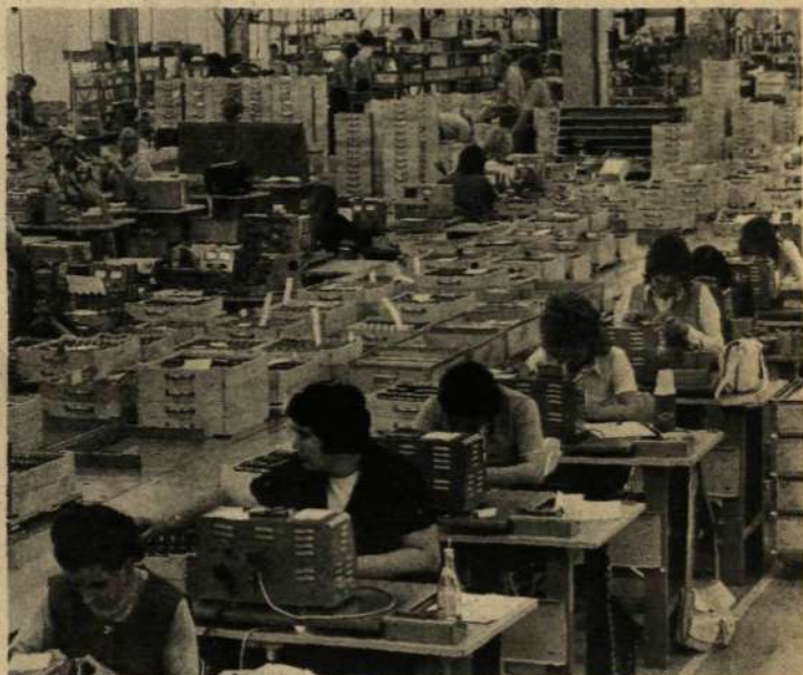
Slutprovning av reläer i en del av den nya produktionshallen. I mitten transportband för materielförsörjning.
