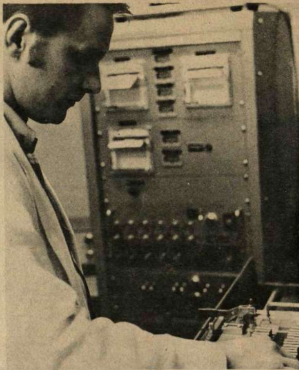
... som tas om hand för slutkontroll av Stig Törnkrantz i mätcentralen — ett elektriskt avskärmat rum med stabil temperatur och luftfuktighet där det yttersta ansvaret för alla elektriska mätningar vilar.
