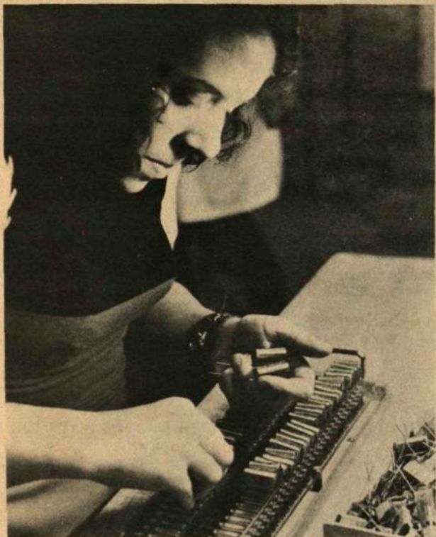
Här monterar Greta Karlsson statistiskt utvalda RC-enheter i en mät-ram ...
