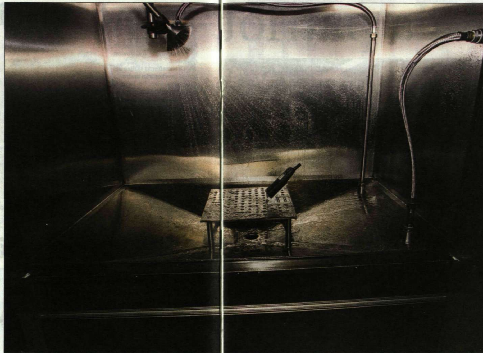
Vissa telefonmodeller måste klara regn och hög luftfuktighet. Här testas telefonerna under en dusch som avger samma vattenmängd som ett lätt, inhållande regn. Foto: Ecke Küller
