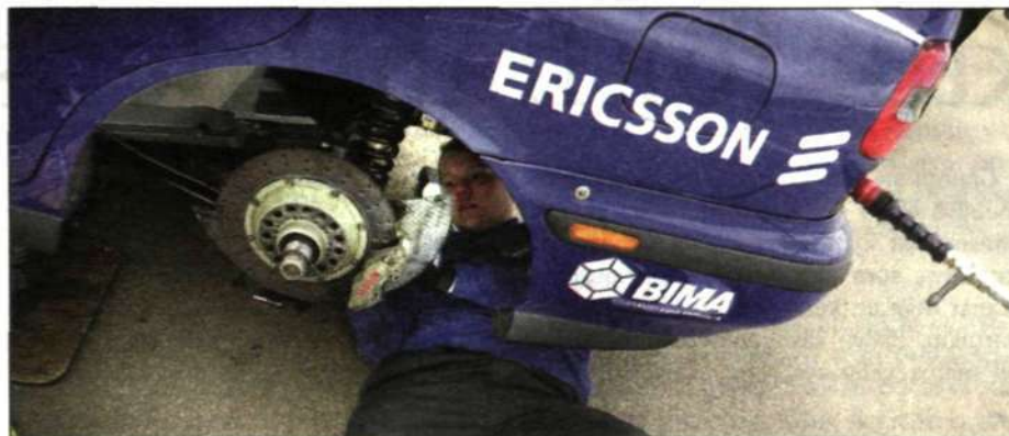
Bilarna servas ständigt under testerna. Bromsarna är självklart kraftigare dimensionerade än de som sitter på en standard Volvo S40.
