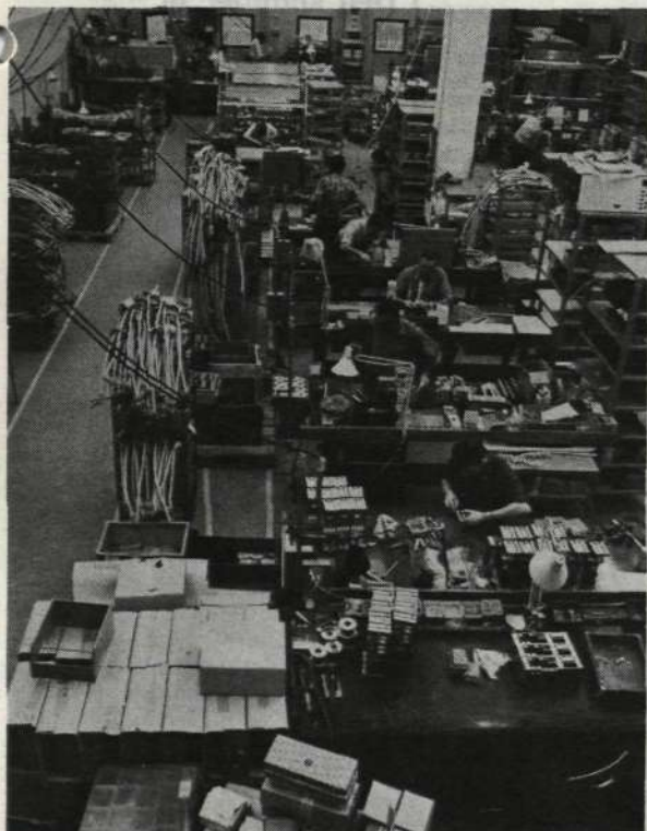
Ett av Dansk Signalindustri fabrikslokaler ute vid Avedøre Holme. I den här montageavdelningen dras bl a kabel till relägrupper och relästativ som ingår i t ex signalutrustningar för järnväg.
