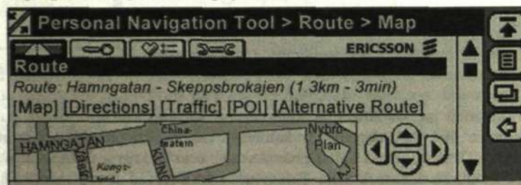
Den rullbara kartan visar vägen, samt avståndet och restiden. Den kan också zoomas in och ut. Ett klick på Directions ger vägbeskrivningen i text. Man kan också spara vägbeskrivningen för att använda den igen eller sända den som meddelande till någon annan.
