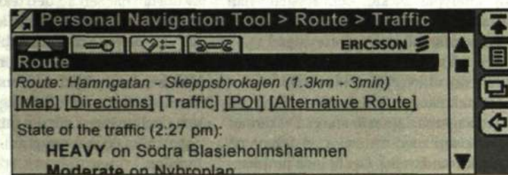
En del av systemet håller reda på trafiksituationen efter den väg man vill ta. Man kan också prenumerera på trafikinformation på en bestämd sträcka och till exempel få ett meddelande på morgonen om hur det ser ut på vägen till jobbet. Alternativ-funktionen ger förslag på andra resvägar för att slippa köerna.
