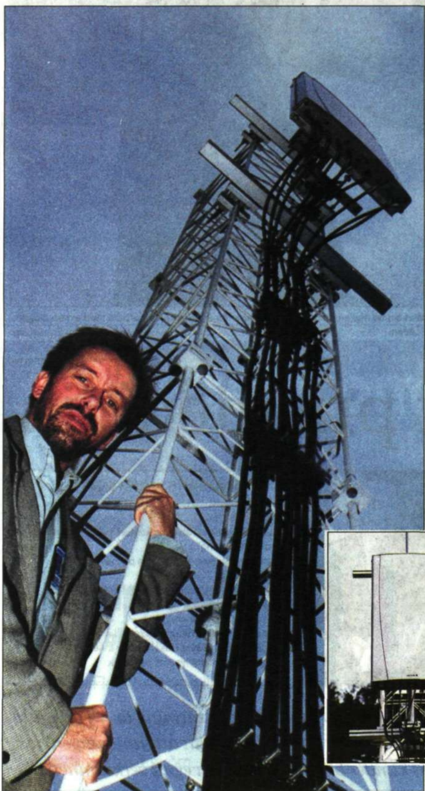
Det är i den breda antennen hemligheten sitter. "Med adaptiv teknik som delar cellen i åtta delar kan vi minska störningar och få mer än fördubblad kapacitet i nätet," berättar Johnny Widén på Ericsson Microwave Systems. Foto: Niclas Henningsson
