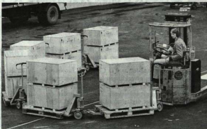
CL-nytt: Truck-tåg med sex vagnar på väg ut till lagret. Lyftvagnarna har lastats i ett av packrummen med lådor på pall, två och två. I varje trucktåg ingår 4 till 6 vagnar. Truckföraren heter Lars-Olov Eriksson.
