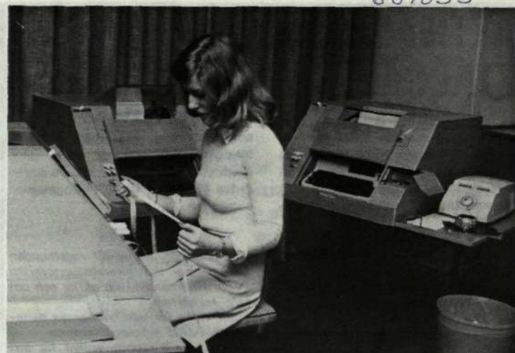
Telexapparaterna är för närvarande konstruerade på mekanisk basis. Utvecklingen går emellertid mot en elektronisering och då i första hand betr sändare och mottagare av telegraftecknen i apparaten.
