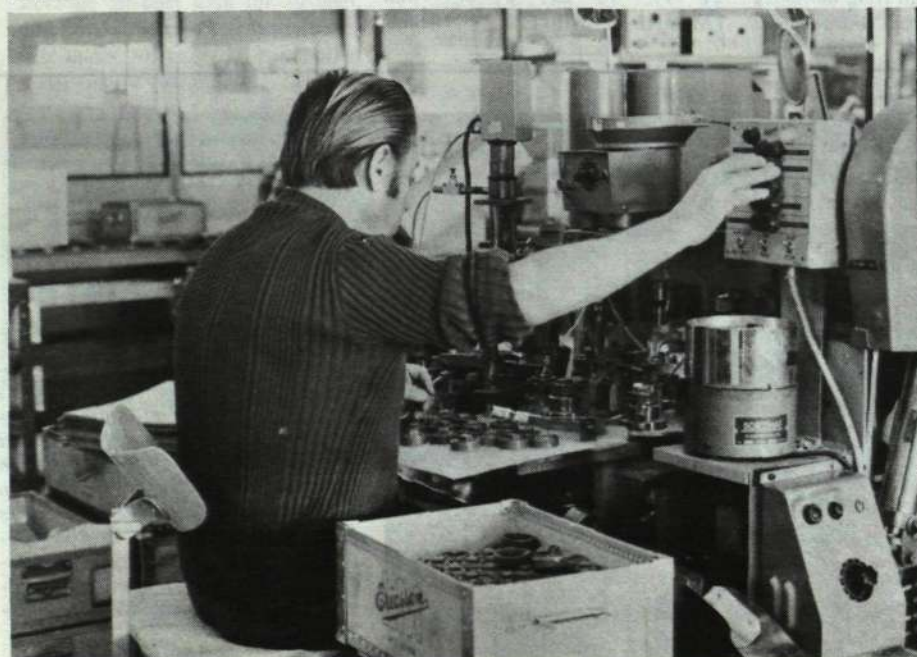
Vlastimil Smida, bördig från Tjeckoslovakien, ar- betar med nitning och skruvning av hörtelefon- kapsel.
