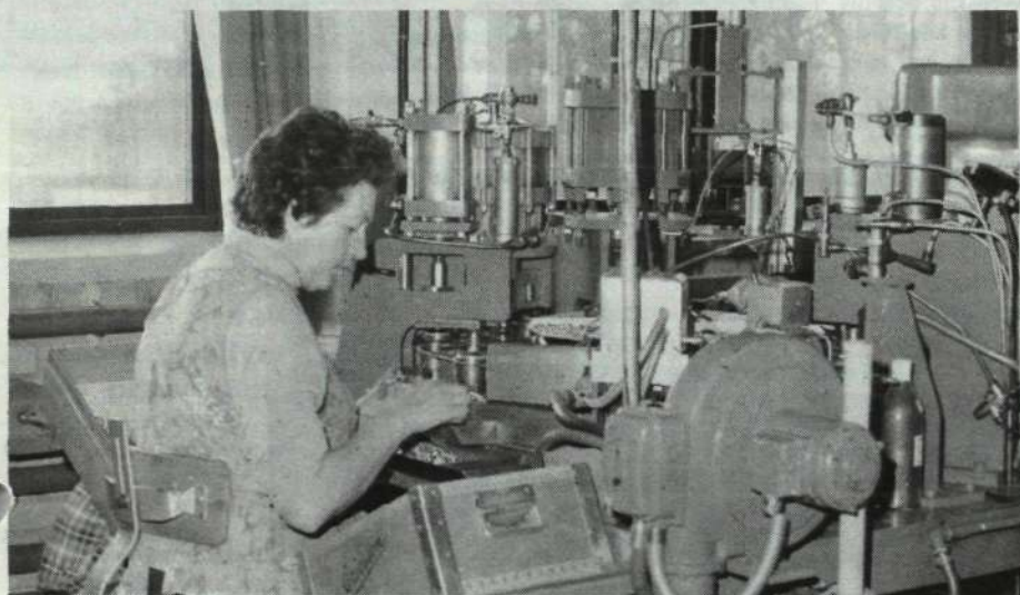
Gunhild Abramsson monterar mikrofonkaps- lar i en kapselautomat.
