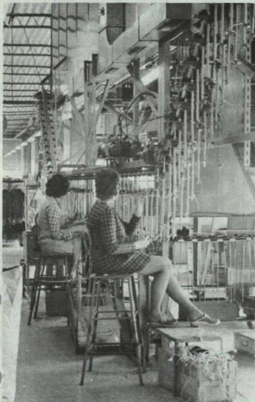
Doris Persson (t v) och Kerstin Olsson arbetar med spiralisering av te- lefonsnören.
