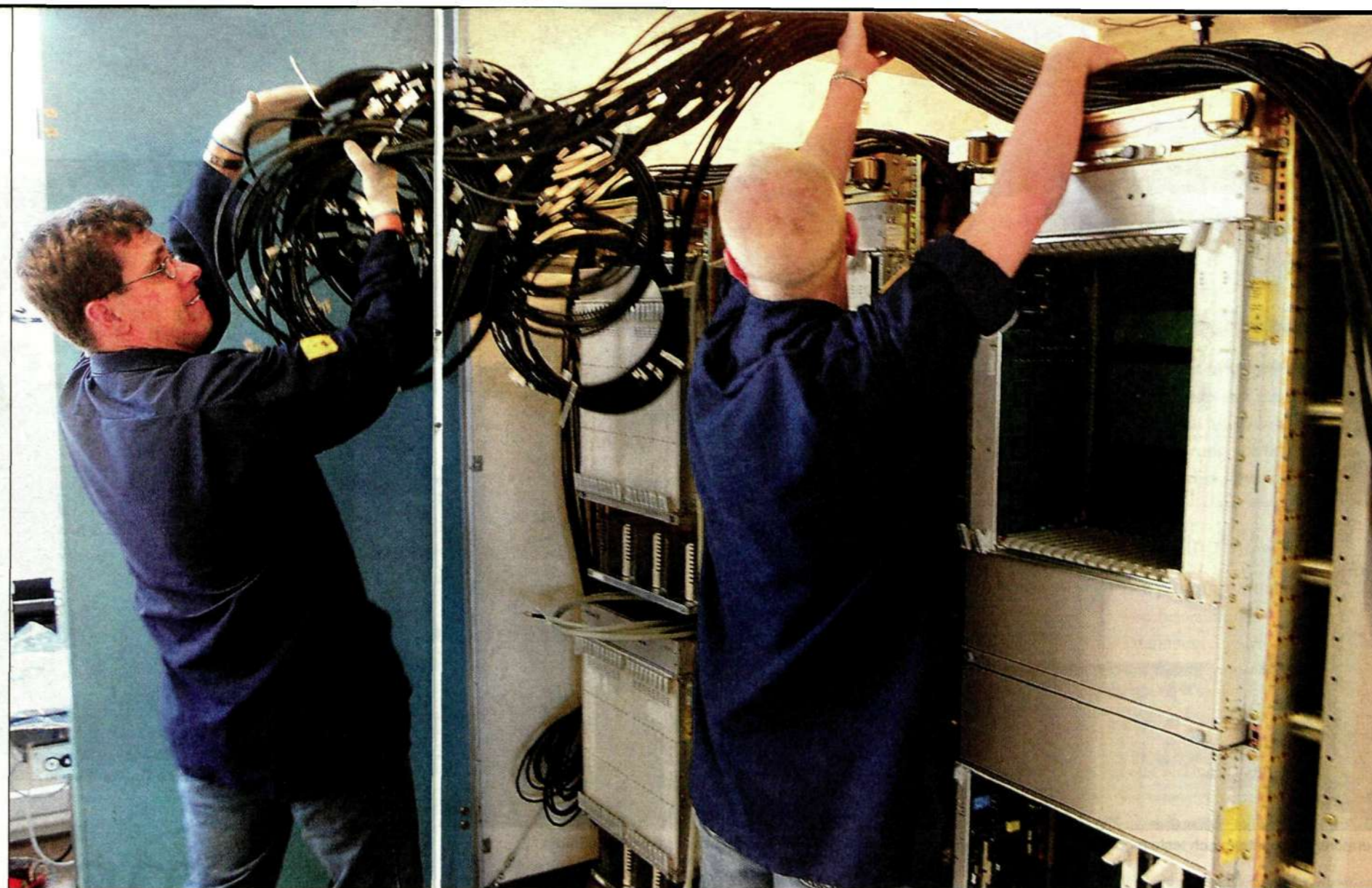
Örjan Björkdahl och Fredrik Hagman på Ericsson Nodmontering i Katrineholm ordnar kabellaget på de noder som ingår i den senaste leveransen till France Telecom.
