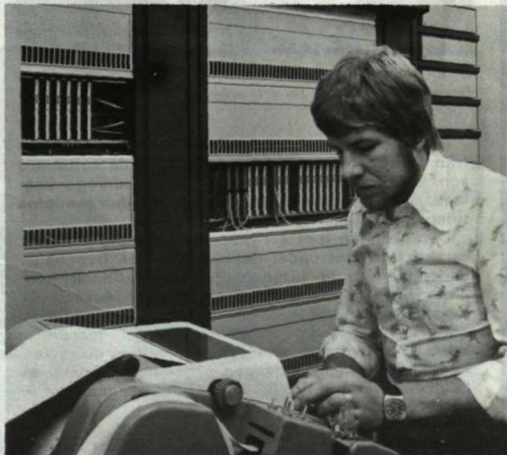
Provning av en helelektronisk datorstyrd station för telextrafik. Den har utvecklats inom ELLEMTEL, det av LME och televerket gemensamt ägda utvecklingsbolaget. Televerket har i dagarna beställt ett exemplar av den nya stationen för drift i Malmö.
