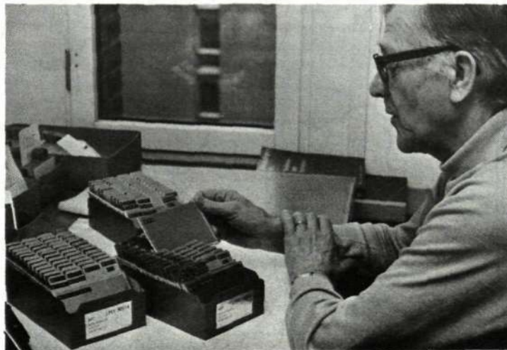
Oscar Klingvall på Standardiseringsavd (LME) håller upp ett färgprov i den färglikarsats som ska användas för att bestämma vilka nyanser våra produkter ska ha. I varje sats ingår 47 färgprov. Femtiotal sats ska till att börja med färdigställas för bl a våra konstruktionsavdelningar.
