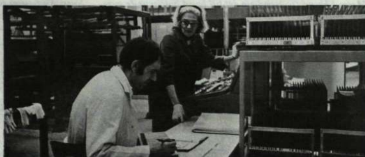
Astrid Engelke och Jerzy Skowronek, chef för ytbehandlingen, trimmar in automatlinjen där guldmattlering av kortets kontaktfingrar görs.
