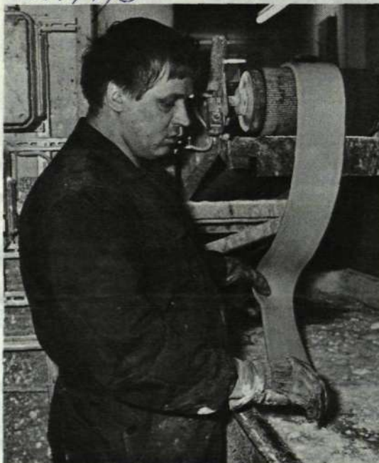
Harry Eklund tar hand om det till band hoppresade gummit. Handskar och skyddskläder är minimiskydd på den här avdelningen.
