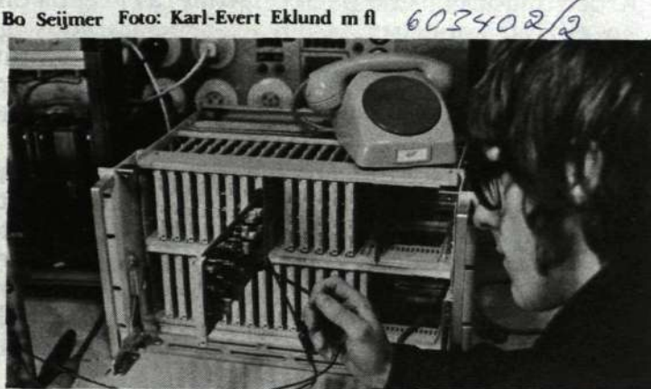
Prövmätning av ett kretskort i talmaskinen. Talet alstras elektroniskt utan rörliga delar, band eller skivor.
