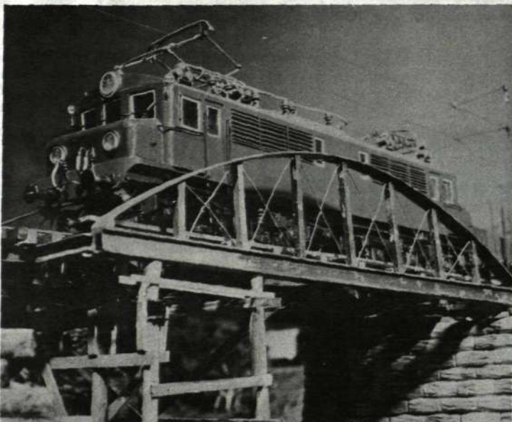
Ett av el-loken i modellanläggningen. Fundament för större bro är under byggnad. Loket drivs från kontaktledningen med 2,4 V likström.
