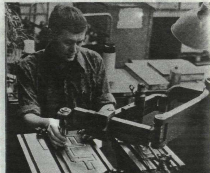
Erik Johansson ses här arbeta med den nya metoden att kopierfräsa planledarkort med hjälp av aluminiumplåt.
