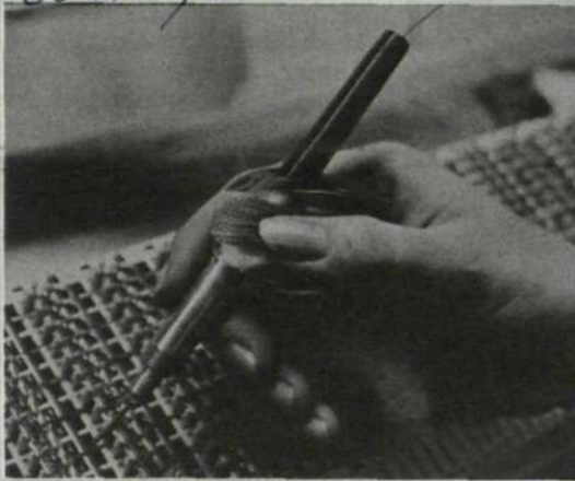
Detta är ett av provexemplaren på den nya trådföraren. Lägg märke till det provisoriskt utformade handgreppet.
