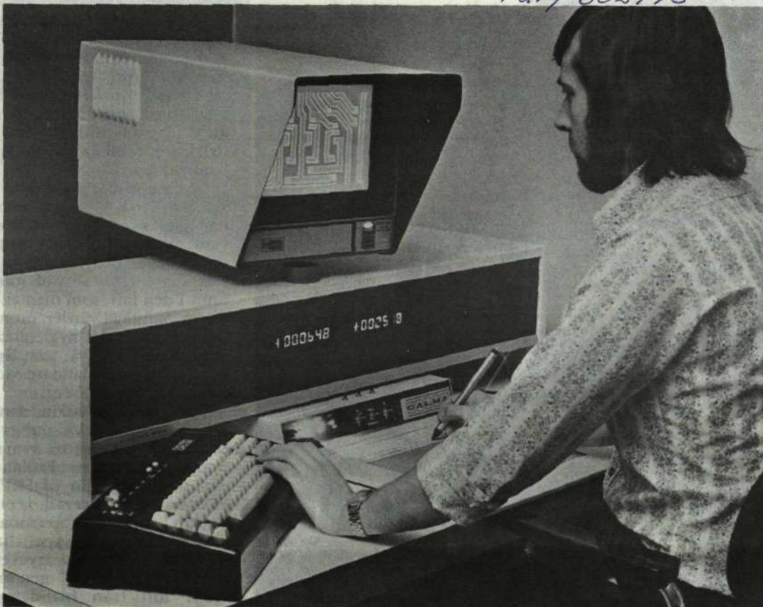
Framställning av layoutmasker för kretsarna har tidigare varit en tidskrävande procedur. För kort tid sedan inköptes ett datorsystem som avsevärt förkortar tiden på detta arbete. Här kontrolleras riktigheten i ett mönster för en monolitikrets. Överst (på båda sidor om rubriken) ses en stark delförstoring av en monolitikrets. Var och en av kretsarna upptar en yta av blott en mm 2 .
