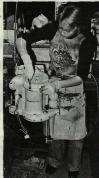
Ann-Britt Johansson arbetar med slutmontering av värmare.
