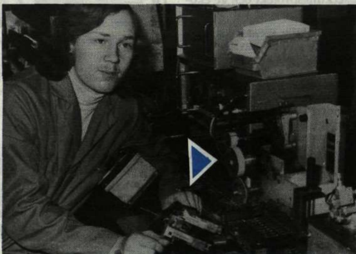
19-åriga Aimo Aro på RIFA i Bollmora vid en av de maskiner för märkning av dioder som tack vare hans förslag nu gör ett bättre jobb med ett enkelt aluminiumhjul (vid pilen) än med den tidigare använda komplicerade och servicekrävande mekanism han håller i handen.
