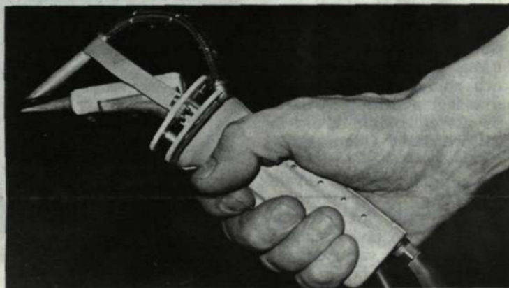
Lödkolv med utsug nära lödkolvspetsen och där lödröken bortföres genom en slang som passerar genom kolvhandtaget. Flera kolvar anslutes till en central fläkt.
