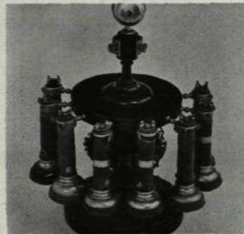
I denna apparat med "stavlampor" kunde fyra personer samtidigt stereolysna på opera direktsänd per tråd i sekelskiftets Stockholm och Paris.
