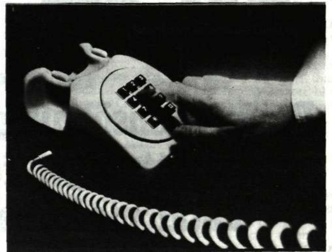
LME har fått en beställning på 10 000 knappsatstelefoner till televerket. Hörtelefon, mikrofonkapslar och väggproppen kommer från Teli och kåporna från LME:s Kristianstadsfabrik. I övrigt är telefonen en produkt som framställs och monterar vid Karlskronafabriken. 33/450
