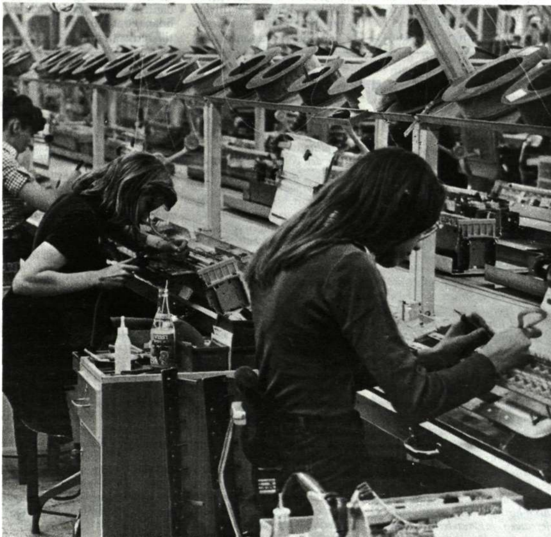
Montering, förbindning och provning av reläsatser dominerar verksamheten vid Örebrofabriken. Här ses en del av de fem linorna för förbindning och slutmontering. Vid linorna jobbar i dag omkring 1 35 kvinnor. Av någon anledning är detta ett typiskt kvinnoarbete liksom provning är ett typiskt manligt jobb.
