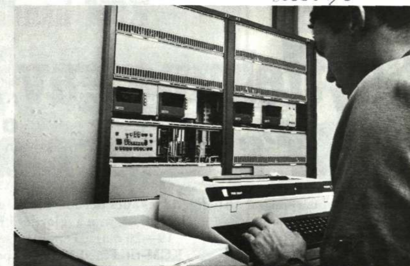
Från kontrollrummet i Södertälje. Elskrimmaskinen används för kommunikation människa - dator i ex för att mata in uppgifter om ändringar i telenätet eller ta emot besked om driftstörningar.
