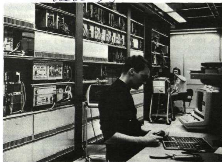
Den dubbelade centraldatorn i AXE under provning på Ellemtel's prototyplaboratorium. Närmast kameran Gunnar Danielsson från Teli (televerkets industridivision). Längst bort Bo Nilsson, Ellemtel.
