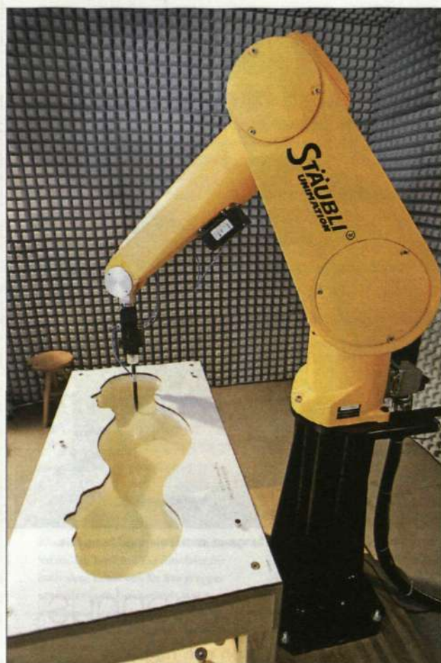
Samtliga Sony Ericssons telefonmodeller SAR-testas innan de släpps ut på marknaden. Vid mätningen använder man ett plastskal som har formen av ett huvud som fylls med vätska som har samma elektriska egenskaper som ett mänskligt huvud. Syftet med mätningarna är att försäkra sig om att telefonerna uppfyller de gränsvärden som gäller för radiovägsexponering.
