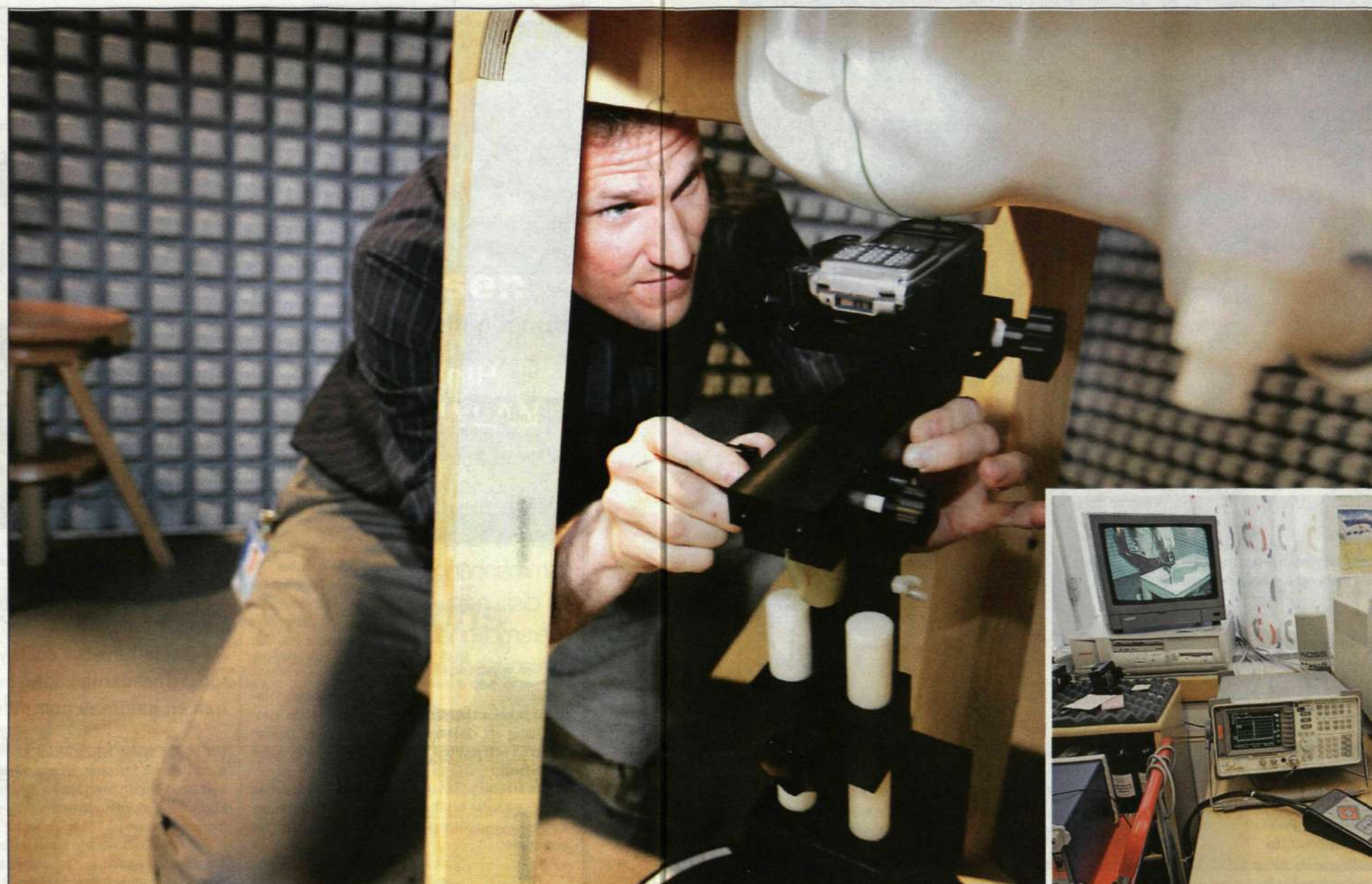
Samtliga Sony Ericssons telefonmodeller SAR-testas innan de släpps ut på marknaden. Vid mätningen använder man ett plastskal som har formen av ett huvud som fylls med vätska som har samma elektriska egenskaper som ett mänskligt huvud. Syftet med mätningarna är att försäkra sig om att telefonerna uppfyller de gränsvärden som gäller för radiovägsexponering.
