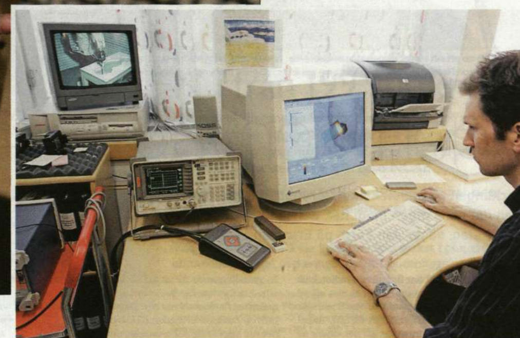
Lennart Hamberg fäster mobiltelefonen i en hållare under ena huvudhalvan innan han börjar mätningen. Från datorn specificerar han mät-punkterna.
