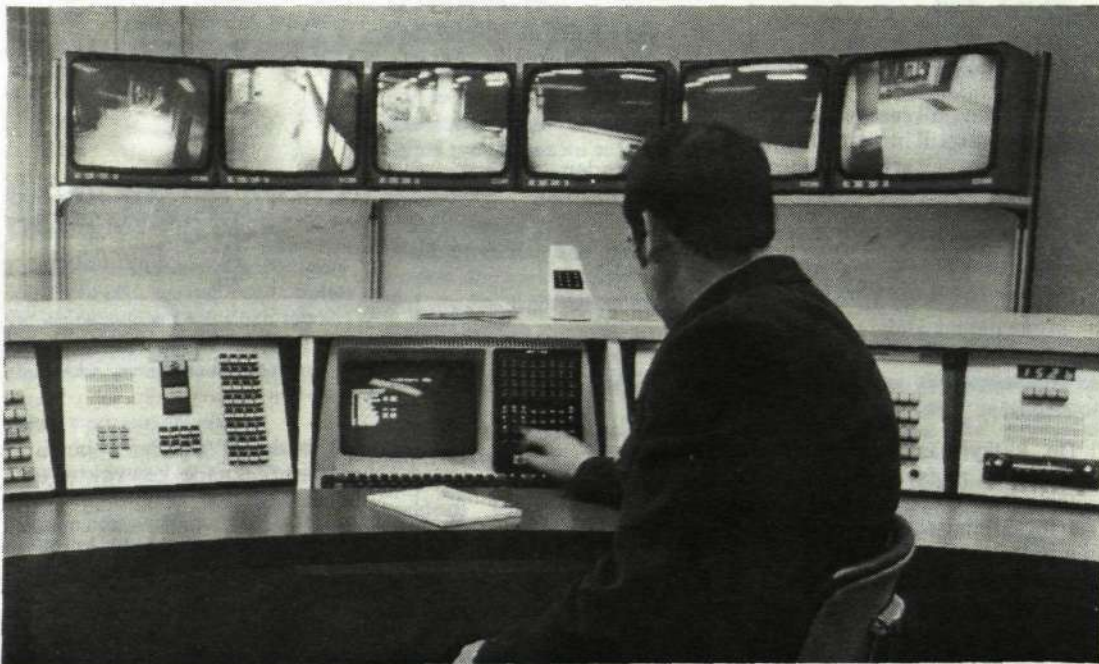
Bevakningscentralen på Sparbankernas Banks huvudkontor i Stockholm. Hit samlas förekommande larm som presenteras i klartext på bildskärmen.
