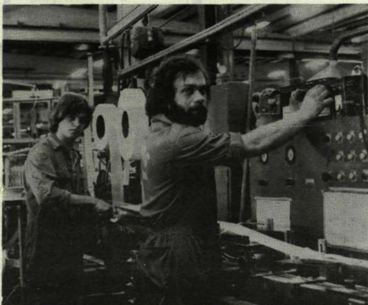
Kabeln ELLALPL-V är en komplicerad tillverkning och innehåller ett flertal isolerande lager, därav de många bokstäverna i kabelbeteckningen. Här läggs en fuktbarriär på av Hans Lundgren (t v) och Eje Eliasson.
