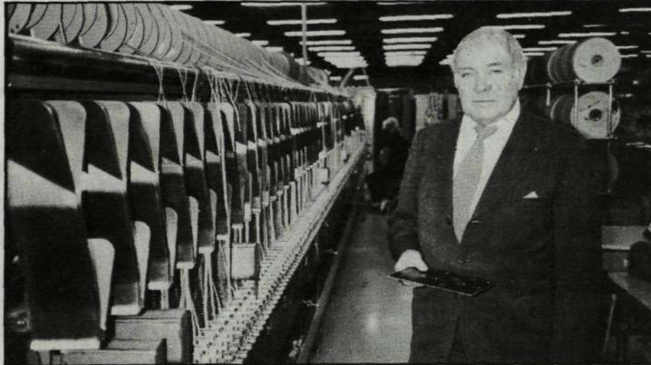
Ingelstachefen Åke Bidö bredvid en s k sekvensbandare. Maskinen sätter upp komponenterna i en bestämd ordning i ett band som i sin tur matas in i en automatisk komponentmonteringsmaskin.
