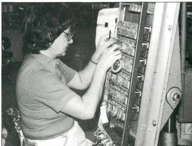
Tatjana Björkman visar konventionell förbindning av sista reläsatsen i gamla LME-fabriken i Örebro.
