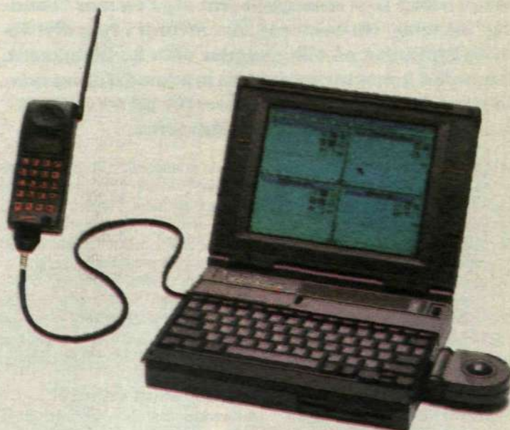
Texas TravelMate med inbyggt Ericsson modem uppkopplad till en Ericsson ficktelefon, NH97.
