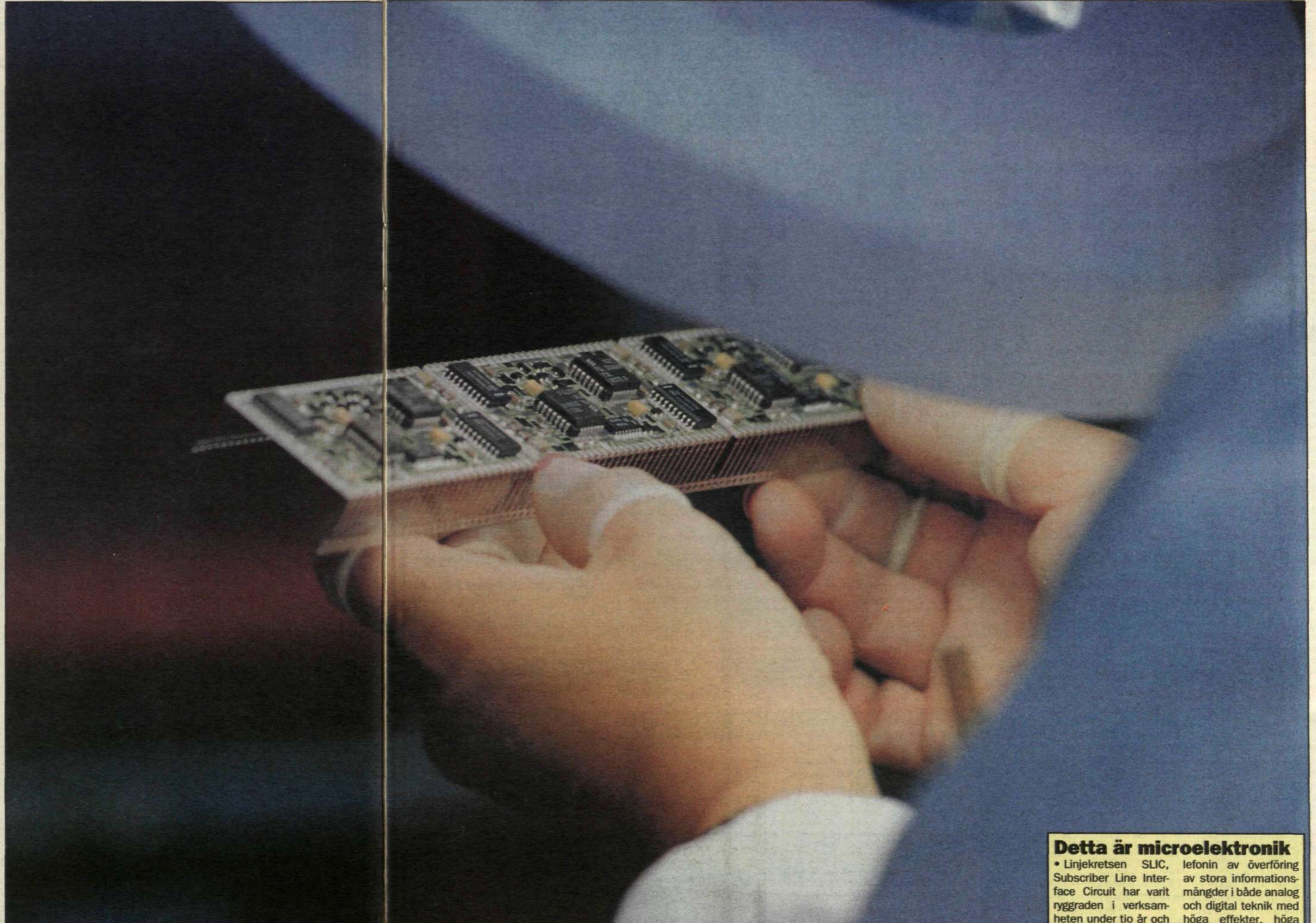
CLIC, som är en komplett linjefunktion, tar emot ringsignaler, kopplar samtal är en storsäljare bland annat i Kina. Affärscenter Hybrider och Motståndsnät.
