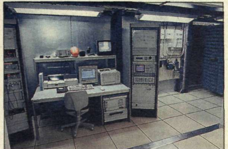
Testerna styrs från kontrollrummet. Med hjälp av datorn kan man till exempel lägga ut olika typer av kraftfält kring det föremål som ska testas, och se hur det skulle reagera i en viss situation.
