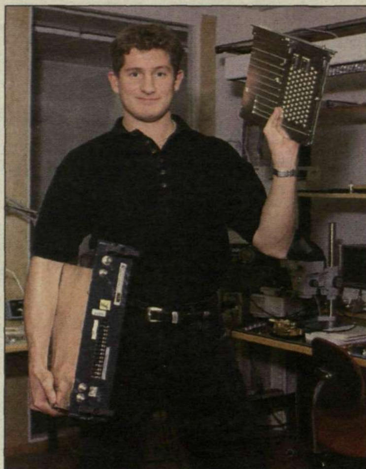
Jens Malmödin har under Arne Tolvgårds handledning gjort en livscykelanalys på en gammal och en ny radiobasstation. Sändardelen, den sk transceivern, väger i den nya knappt 1,5 kilo, i den gamla 10 kilo. Miniaturisering ger i alla avseenden bättre miljöindex; mindre materialåtgång, billigare transporter och viktigast av allt, lägre effektförbrukning. Foto: Björn Seger
