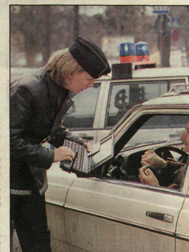
Med radiomodemet instuckat i en bärbar PC kan polisen smidigt göra bl a körkortskontroller.
