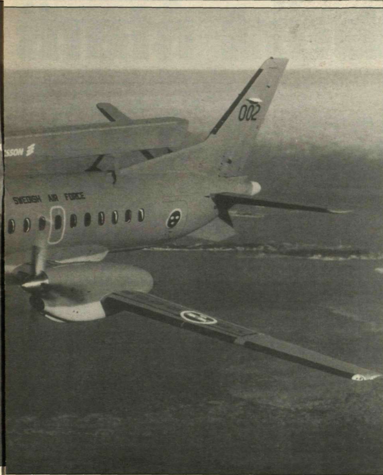
fastnade för att montera antennen på planet rygg. Det har funnits varianter där radarn hängt under planet buk, under en helikopter (dyrt), där den monterats på planet vingar, där man haft radarn infälld i ett vridbart lastutrymme (instabilt) osv.
