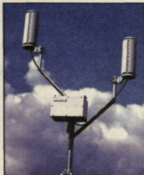
Basstationen (DECT accessnod) täcker behovet för upp till 600 abonnenter och har en räckvidd på några kilometer.
