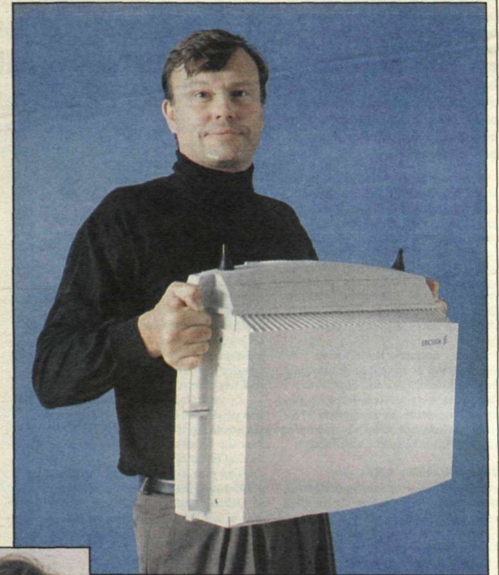
Prototypen till världens minsta basstation för mobiltelefoni är bärbar och väger under 25 kilo (bilden ovan).
