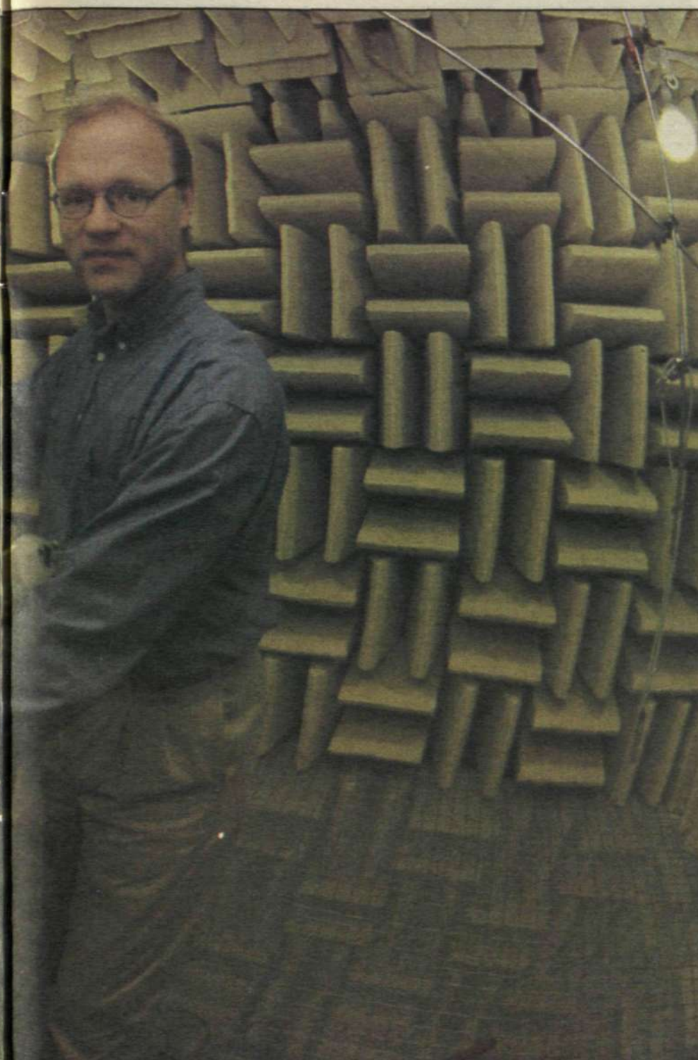
Ett eget "tyst rum" kvalificerar Ericsson för en plats i en tämligen liten och exklusiv församling. I Sverige finns endast ett fåtal liknande rum, bland annat hos SAAB, Volvo, de tekniska högskolorna och Statens Provingsanstalt SP. Ovan är Tao Li, Åke Janzon och Sune Gustafsson i full färd med att förbereda en "artificiell människa" för test av en telefon i Dialog 3000-serien. Foto: Thord Andersson, illustration: Bernhard Zirm
