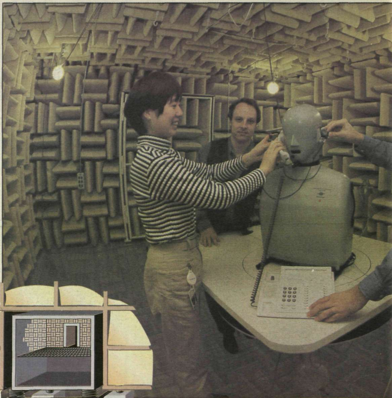
"Tysta rummet" har måtten 7,4 x 5,8 x 5,2 meter. Det består av betong gjuten upp till halva höjden och därefter murad med betongsten upp till taket, som består av gipskivor. Rummet står på fjädrar som vilar på en platta som i sin tur står på pelare ner till berggrunden. "Tysta rummet" representerar en investering på 1,7 miljoner kronor och är konstruerat och byggt av G+H Montage i Ludwigshafen, Tyskland.
