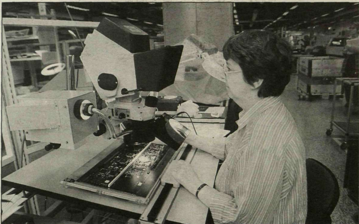
Avtalet ger Ericsson och Marconi ensamrätt på marknadsföring av den gemensamma SDH-produktportföljen. Ericsson kommer att börja licensstillverka Marconis produkter i Norrköpingsfabriken under 1996. Här kontrollerar Yvonne Ferin tillverkningen av transportnätprodukter, att alla komponenter är ordentligt fastsatta på kretskorten. Foto: Björn Larsson
