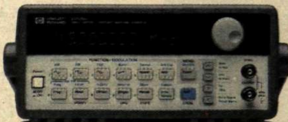
HP 33120A Funktionsgenerator Kan generera godtyckliga kurvformer
