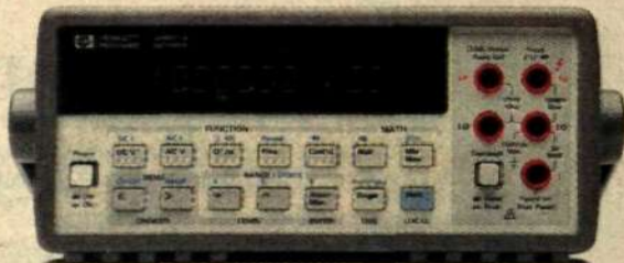
HP 34401A DMM Multimeter med 6 1/2 siffrors upplösning.
