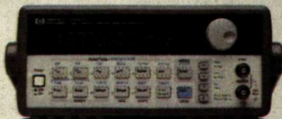
HP 33120A Funktionsgenerator Kan generera godtyckliga kurvformer
