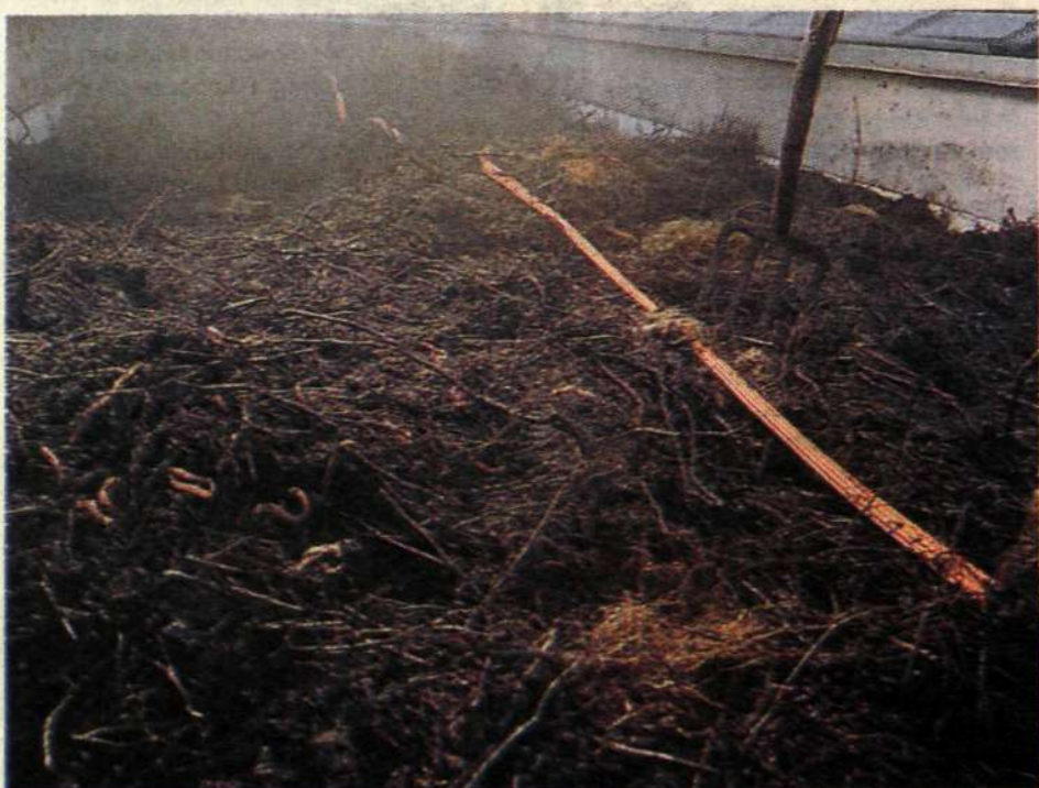
Vid Ericsson Telecoms fabrik i Norrköping finns ett biologiskt filter där maskar tar hand om svårnedbrytbara lösningsmedel. För den här anläggningen fick Ericsson brittiska BTs miljöpris 1995.
