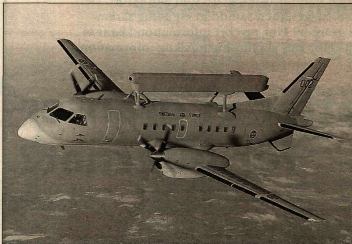
Den flygburna radarn Erieye är så lätt att den kan monteras ovanpå ett vanligt flygplan, här Saab 340, den modell som Försvarets Materielverk valt till de sex radaranläggningar man köpt från Ericsson Microwave Systems.
