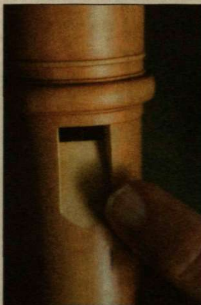
Från flöjtens labium till överkanten på vindkanalen krävs en noggrannhet på ett par hundradels millimeter och för att hålla denna precision vid tillverkning krävs en mycket speciell maskin.
