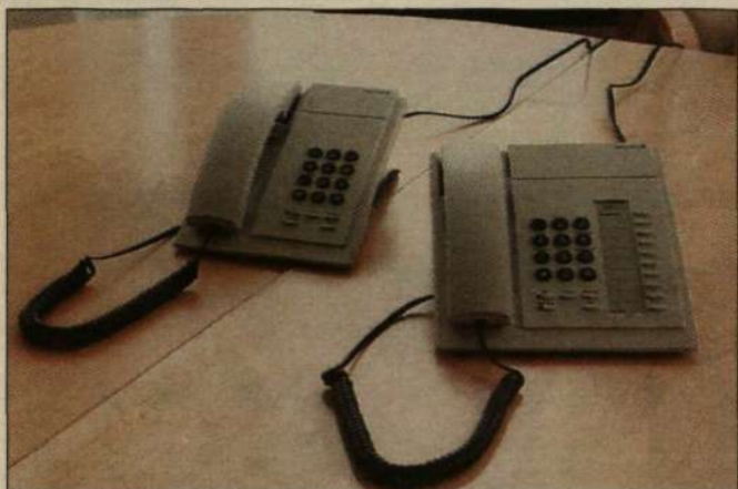
Två av de fyra nya analoga telefonerna i Dialog 3100-serien med samma eleganta design som de mer avancerade digitala apparaterna. Till vänster den enkla basapparaten (Dialog 3105) med minsta möjliga finesser. Den säljs mest i Latinamerika. Apparaten med namnvalsknappar (Dialog 3145) som också har inbyggd vänthögtalare säljs framför allt i Europa och i Sydostasien.
