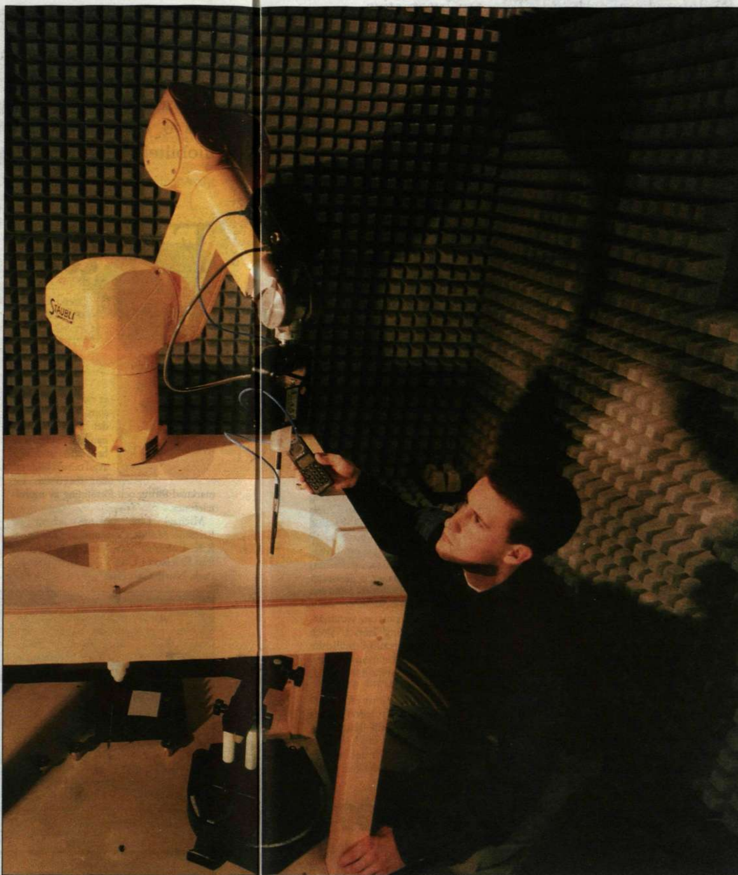
Martin Siegbahn förbereder mätningen av exponeringen från en mobiltelefon. Vid mätningen placeras telefonen på stativet under den nersänkta delen av bordsytan till höger, som formats som ett människohuvud.
