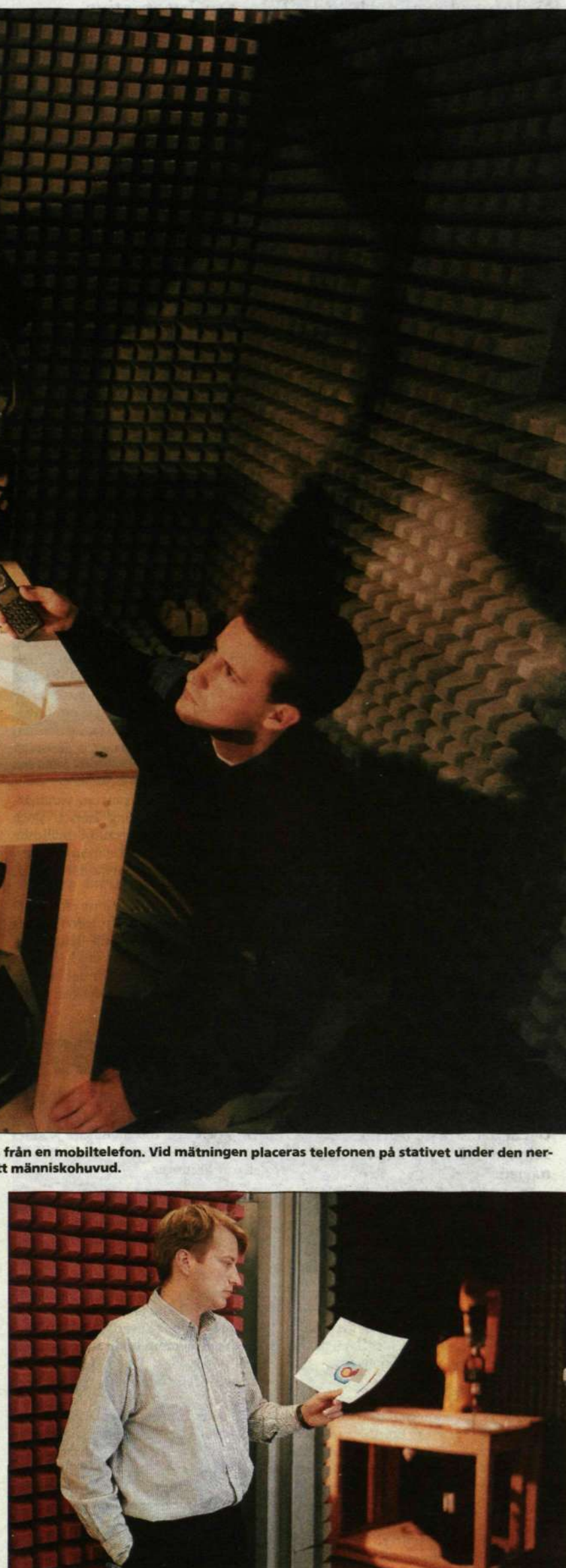
Christer Törnevik studerar mätvärdena för den senaste mobiltelefonmodellen. För att få rättvisande resultat testas fem slumpvis valda exemplar av varje modell.
