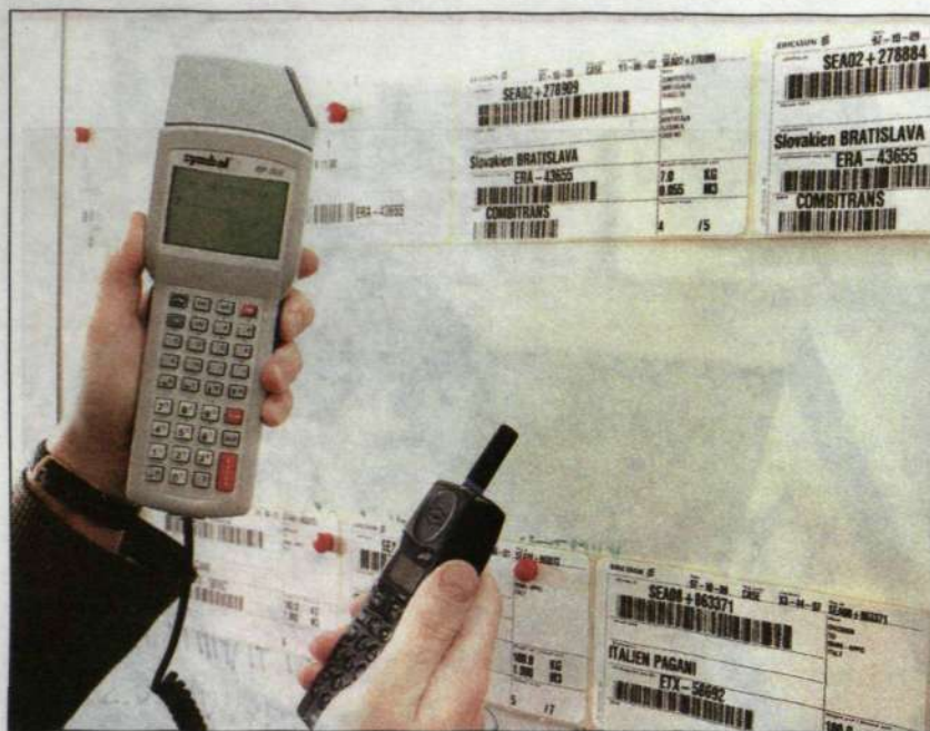
Strekkodsläsaren kopplad till en GSM-telefon ger snabb och säker informationsöverföring av kollnummer, sändningsnummer etc. Foto: ANDERS ANJOU
