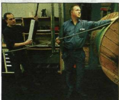
Per Flöjt och Jan-Erik Norin spolar här upp en optokabel som inte innehåller PVC utan polyten med magnesiumhydroxid som flamskyddsmedel.
