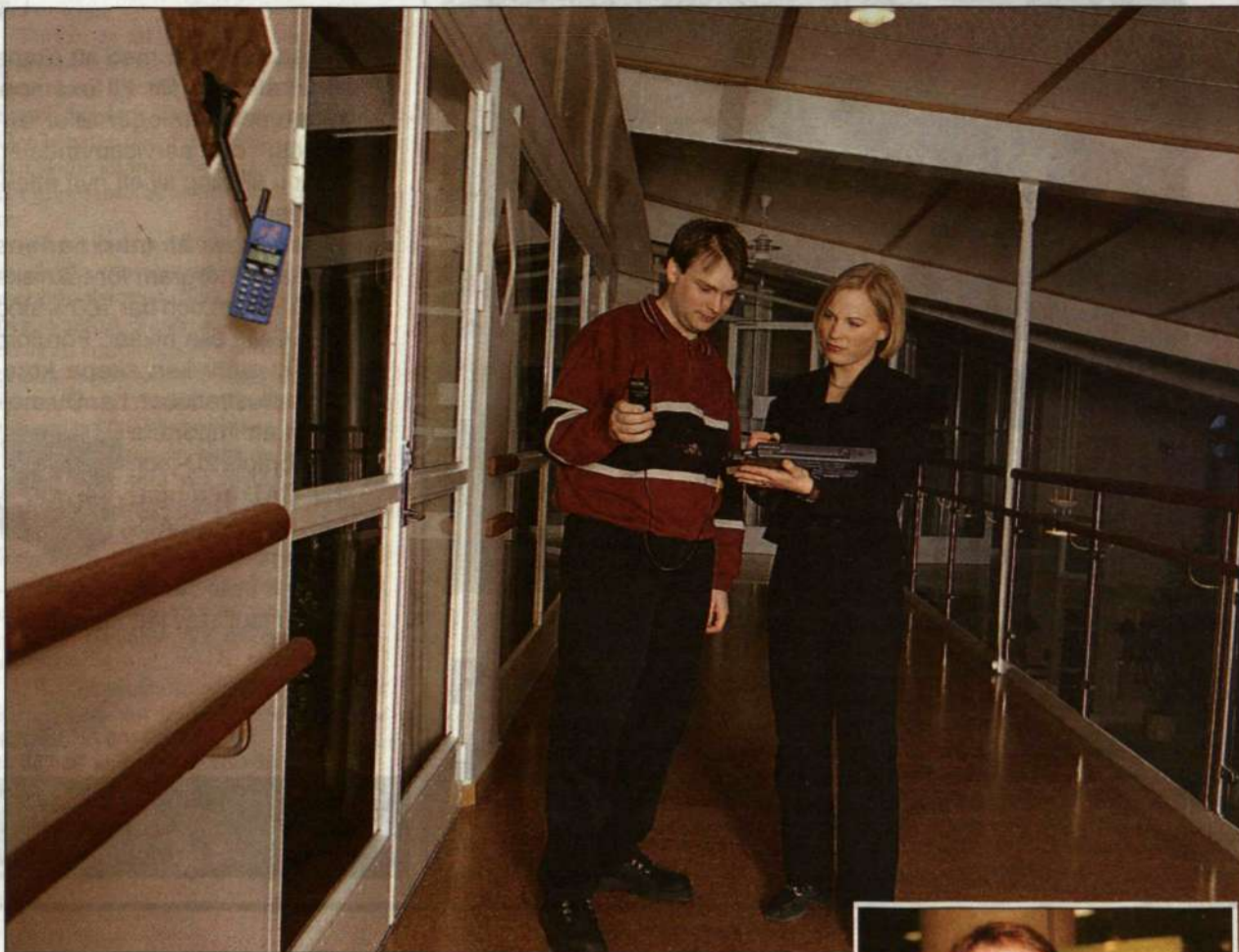
Nya produkter från Ericsson Erisoft underlättar inomhusplaneringen av mobilnät. Niclas Ögren och Annacarin Falkman från Erisoft provar här inomhustäckningen på Scandic Hotell i Skellefteå med hjälp av TEMS Transmitter på väggen och TEMS Light i hand.
