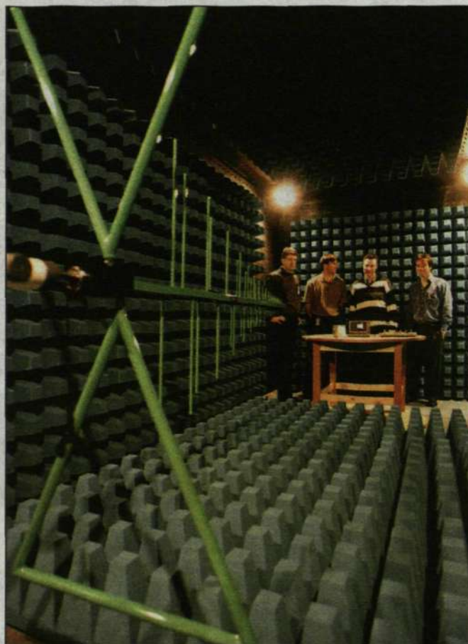
I labbet kan man mäta både hur mycket elektromagnetisk strålning som kommer från en mobiltelefon och hur mycket strålning en telefon klarar. Testkammaren är uppbyggd för att ta bort alla störningar utifrån.
