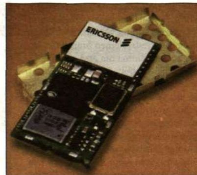
Här är den kompletta Blåtandsmodulen, som levereras med mjukvara. Modulen har små dimensioner (33 x 17 x 3,65 millimeter), låg effektförbrukning och kan anslutas till en mängd olika elektroniska apparater.
