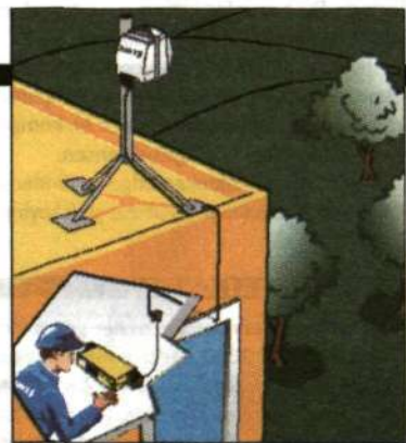
MINI-LINK består av en inomhus- och en utomhusenhet. Enheterna kommunicerar med en koaxialkabel. Illustrationer: Hans Dahlberg
