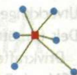
Stjärntopologi. Telefontrafiken från varje basstation leds i ett länkhopp direkt till växeln.
