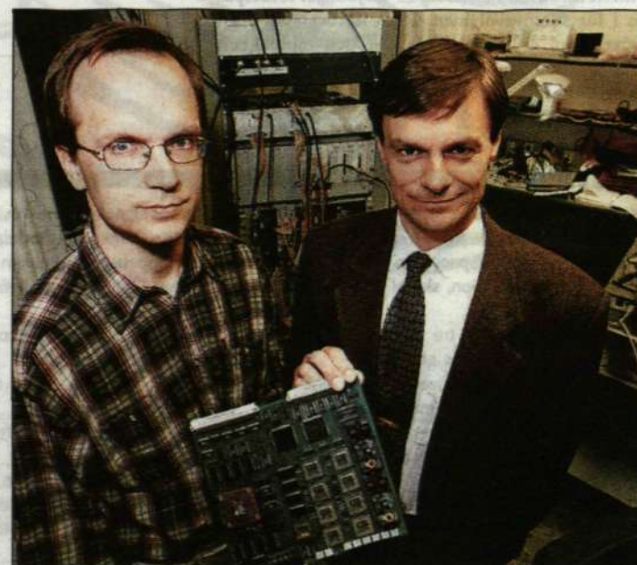
GSM- och TDMA-systemen växer ihop med Edge-tekniken. Jonas Näslund från affärsenheten GSM-system och Ulf Forssen från TDMA-system visar ett utjämnat kort, en del av den nya digitala Edge-tranceivern, som passar i radiobasstationer för systemen.
