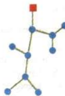
Trädtopologi. Telefontrafiken från basstationerna långt ned i trädstrukturen, på stort avstånd från växeln, leds i länkhopp via basstationer närmare växeln.
